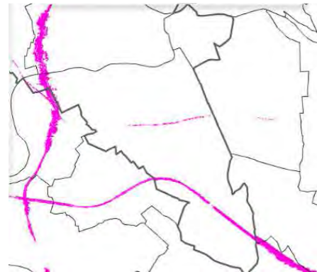
Figure 85 : Fer : Relevés des moyennes de bruit de nuit (Ln) zones de dépassement des valeurs limites réglementaires – carte de type c, source Bruitparif
